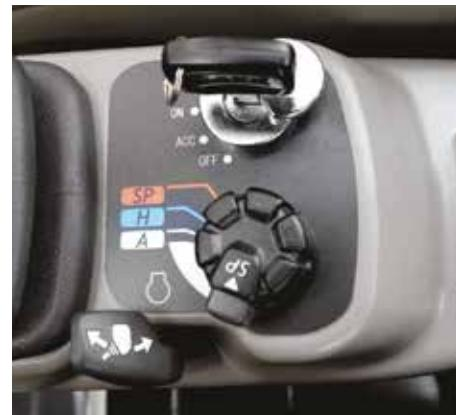
Операторы могут сохранять до 10 дополнительных настроек расхода гидравлического масла (и давления гидравлического масла — опция по заказу), что позволяет им легко и быстро менять навесное оборудование без необходимости каких-либо механических регулировок.
